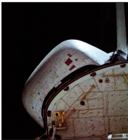
Figure 11 – Vue sur la partie arrière de Columbia. On y voit parfaitement les tuiles manquantes.
