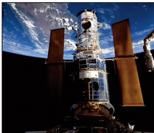
Les panneaux solaire déformés
