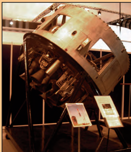
1 er étage avec Gamma-8
