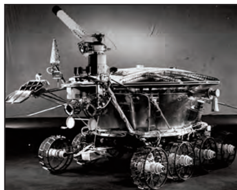
Lunokhod n°108 pour les essais terrestres en Crimée
