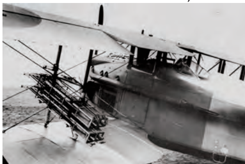
Figure 7b : SPAD VII avec dispositif lance-fusées (noter les tuyères qui dépassent à l'arrière)
