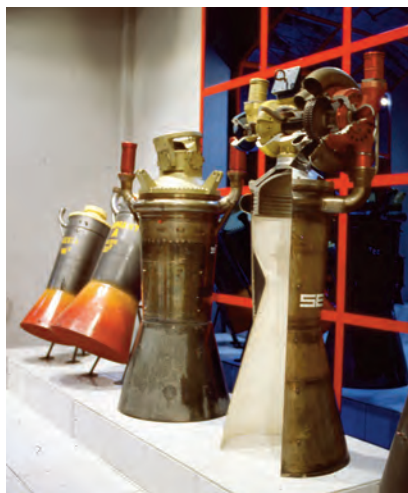
Musée Snecma de Vernon : g à dr, moteurs Vesta, Diamant-A (Vexin de 28 t), Diamant-B (Valois de 35 t) et M-40 (ancêtre du Viking).
